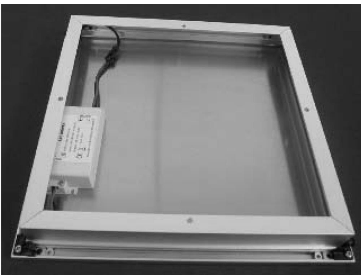
Schritt 6: Befestigen Sie das Panel am Rahmen, indem Sie das Panel in die Halteklammern drücken. Das Panel rastet in den 4 Klammern ein und ist fertig installiert. Der Treiber liegt auf dem Panel im Rahmen. Der Treiber ist im Lieferumfang des Panels enthalten.
