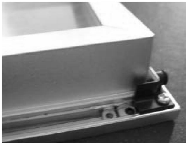
Schritt 6: Befestigen Sie das Panel am Rahmen, indem Sie das Panel in die Halteklammern drücken. Das Panel rastet in den 4 Klammern ein und ist fertig installiert. Der Treiber liegt auf dem Panel im Rahmen. Der Treiber ist im Lieferumfang des Panels enthalten.
