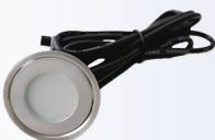
Tipp: die IP67 Einbauleuchten lassen sich in Möbelstücke, Decken- oder Böden im Innen- und Außenbereich integrieren. Die Einbautiefe beträgt je nach Ausführung nur 9mm. Die Leuchte ist einzeln oder im 6er Set erhältlich. Diese und weitere Ausführungen für Akzentgestaltung finden Sie im Kapitel Lichtakzente.
