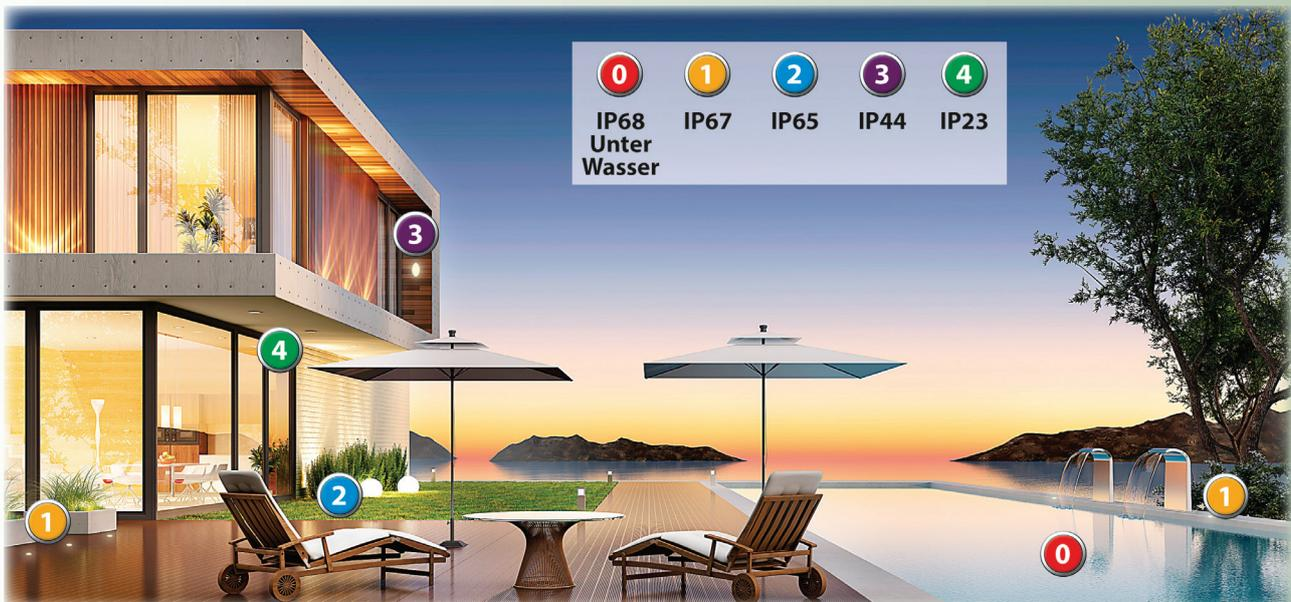
Achten Sie bei der Wahl der Leuchte auf die IP Schutzart. Diese gibt an, wie gut eine Leuchte vor Feuchtigkeit und dem Eindringen von Fremdkörpern geschützt ist. Je höher der Wert, desto besser ist der Schutz.
