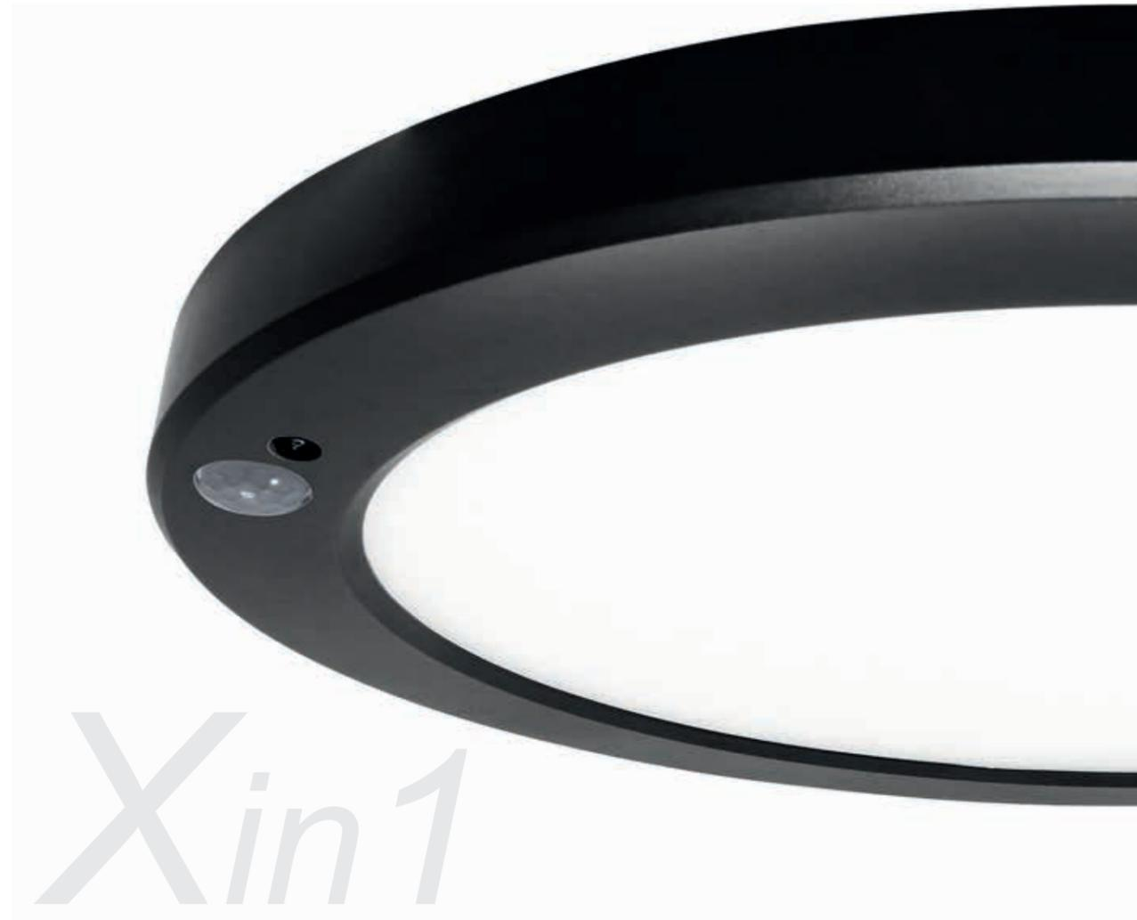
**MULTILED SENSOR** - Entdecken Sie das neue Sensorpanel mit integriertem PIR Sensor. Der Sensor der Leuchte kann auf 30 Sekunden oder 180 Sekunden eingestellt werden. Der Bewegungssensor hat einen Erfassungsbereich von 90°, ca. 3,5m (siehe Bild).
